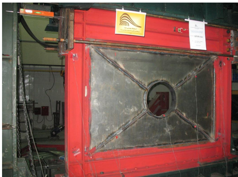
شکل ۶. نمونه SPSW(s4) با ضخامت ورق ۱ میلیمتر و سخت کننده های قطری و گوشه ۲×۲PL۴×۵mm و بازشو سخت شده به قطر ۴۰mm
