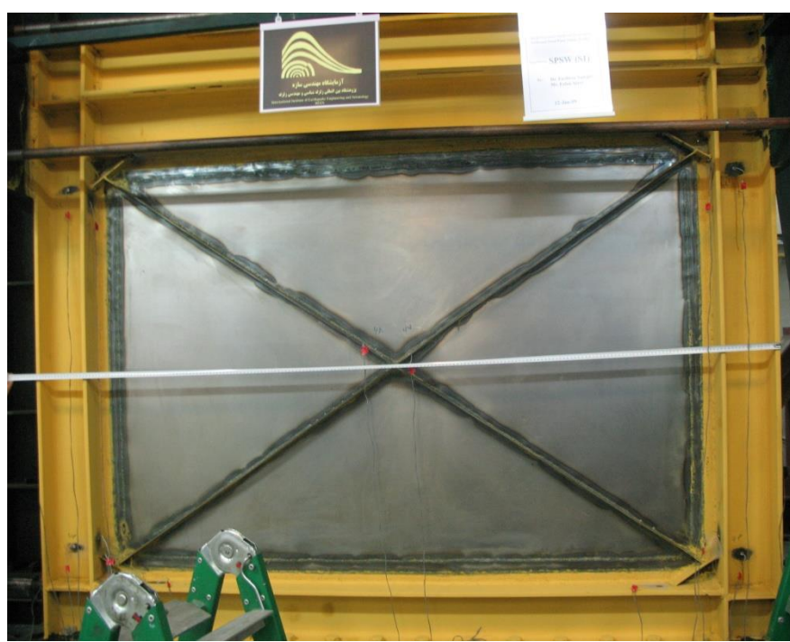
شکل ۳. نمونه SPSW(s1) با ضخامت ورق ۸/۰ میلیمتر و سخت کننده های قطری و گوشه ۲×۲PL۴×۴mm
