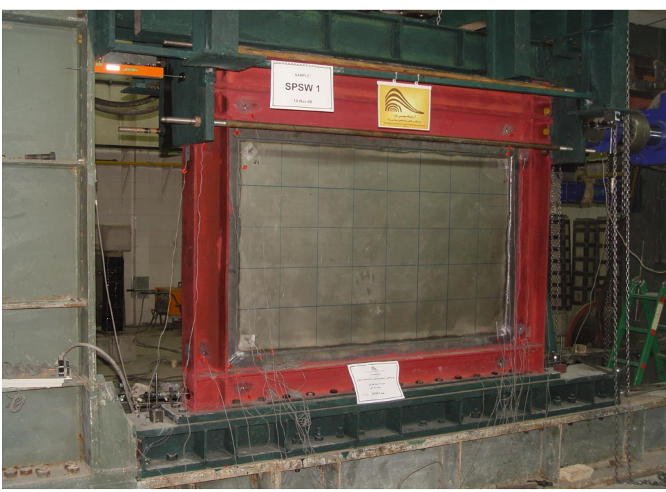
شکل ۱. نمونه SPSW1 با ضخامت ورق ۵/۱ میلیمتر
