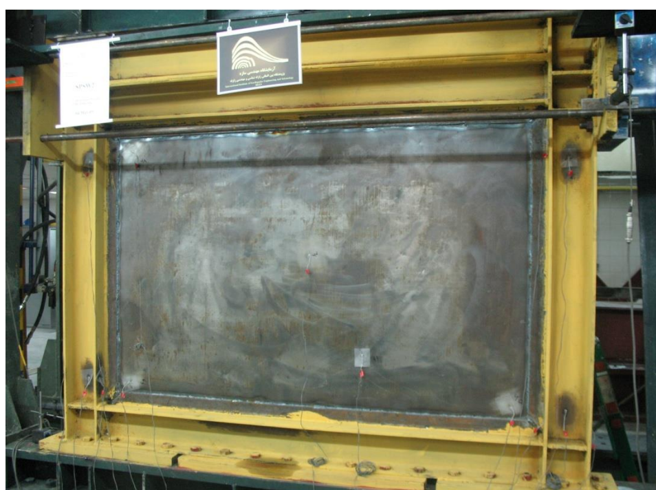
شکل ۲. نمونه SPSW2 با ضخامت ورق ۸/۰ میلیمتر
