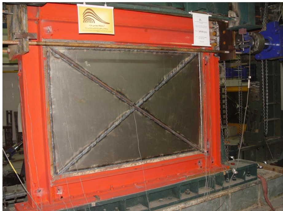
شکل ۵. نمونه SPSW(s3) با ضخامت ورق ۱ میلیمتر و سخت کننده های قطری ۲PL۶×۱۰ با اتصالات مفصل تیر به ستون
